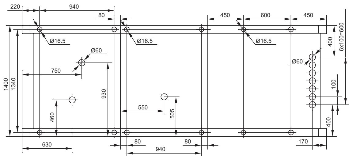
**Габаритные размеры и масса КТППАС мощностью 400 кВ·А**
