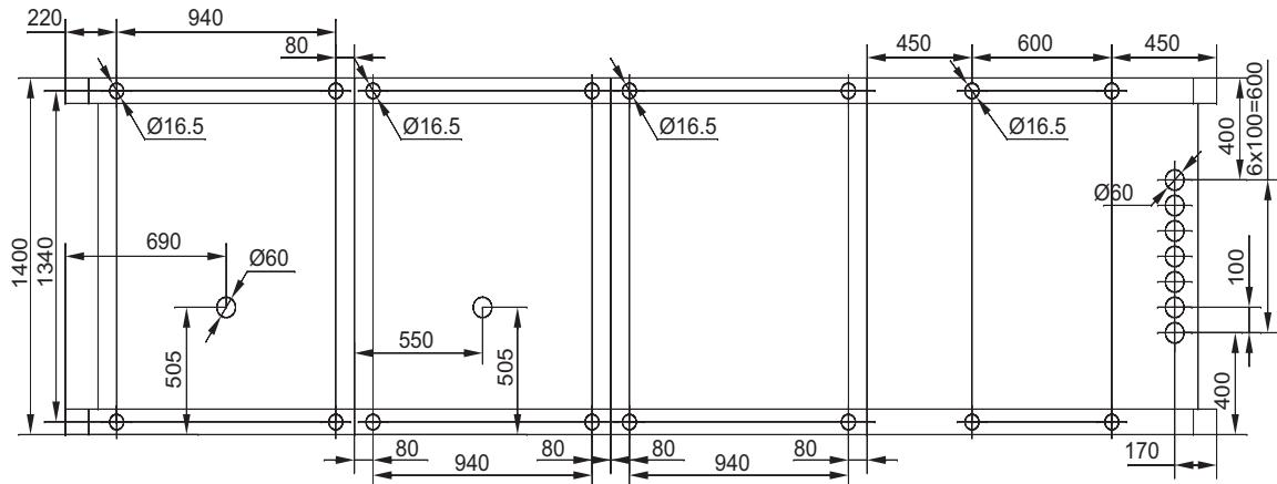
**Габаритные размеры и масса КТППАС мощностью 400 кВ·А
