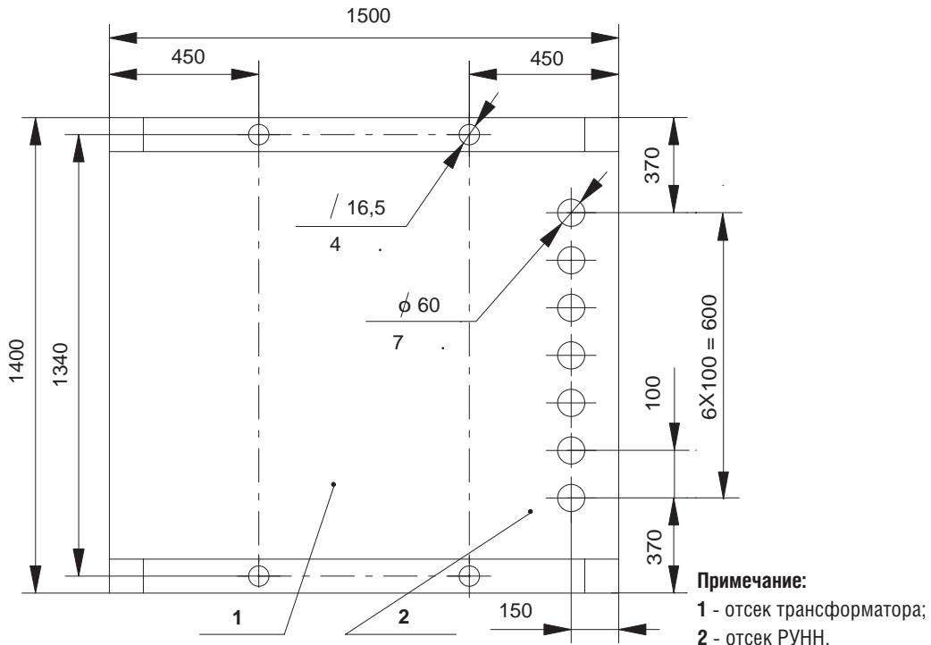
**Разметка отверстий в КТПТАС (с кабельным вводом) мощностью
