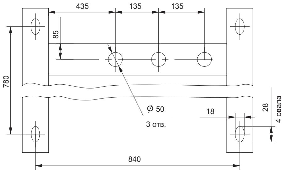
**Установочные размеры КТП-04 мощностью 250 кВ·А для крепления на фундаменте и привязка кабельных выводов**
