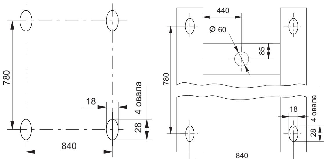
**Установочные размеры КТП-04 мощностью 25...160 кВ·А для крепления на фундаменте и привязка кабельных выводов**
