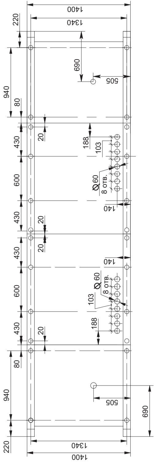
**Разметка отверстий для ввода кабелей НН и крепления на фундаменте
