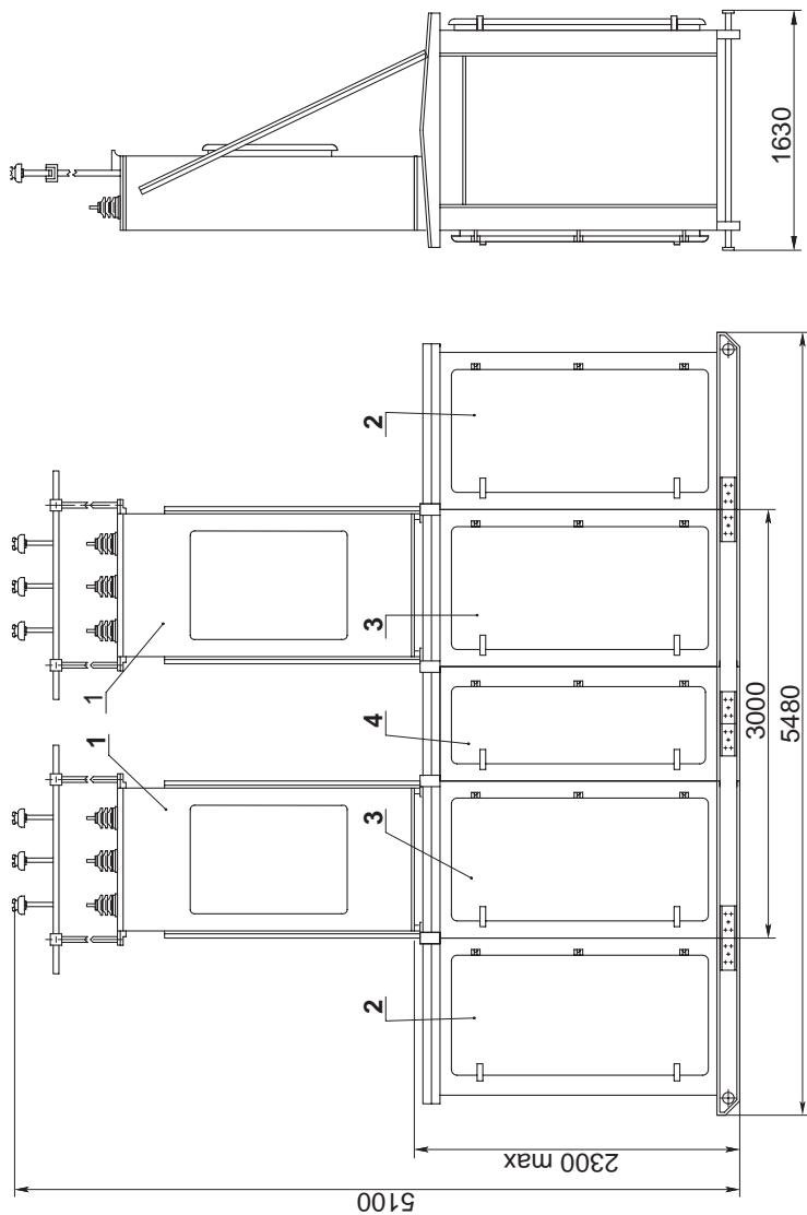
**Разметка отверстий для ввода кабелей ВН и НН и крепления на фундаменте
