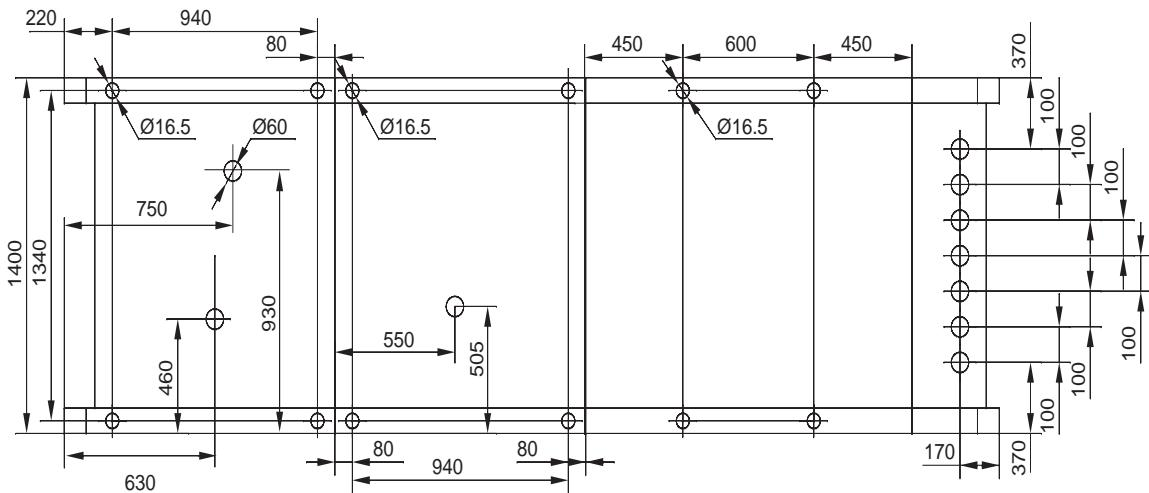
**Габаритные размеры и масса КТППАС мощностью 63...250 кВ·А
